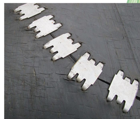
Réparation de la bande
